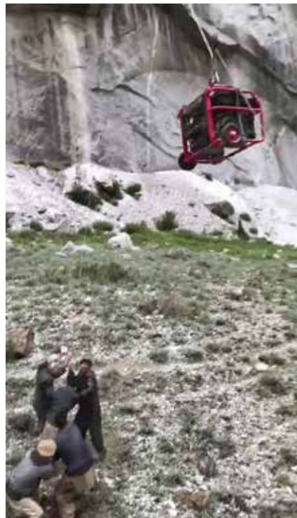
Tag für Tag: Typische Traverse über die Felsvorsprünge zur Abbaustelle. Sogar ein Elektrogenerator wird an Stahlseilen zum „Hauptquartier“ hochgezogen
